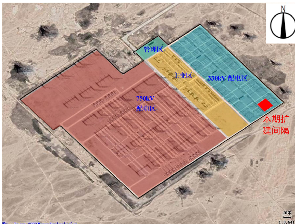
图 3.1-1 河西 750kV 变电站总平面布置图
