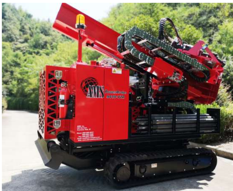
图 5-2 Powerprobe 9410VTR 履带式直推取样钻机
