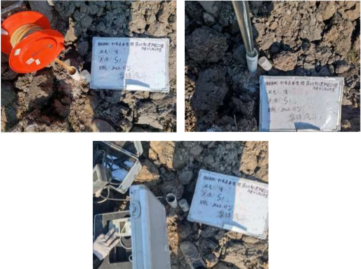
图 5-9 地下水采样洗井
