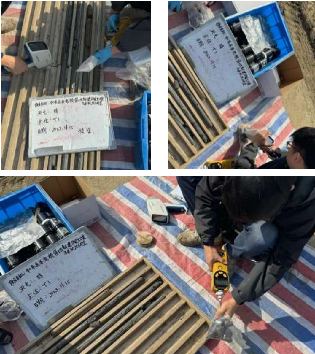
图 5-4 现场 XRF、PID 校准及快筛
